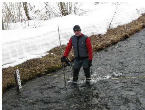
Slika 48: Vodomerna postaja Kranjska Gora, opremljena z vodomerno letvijo (ARSO, 2012)
