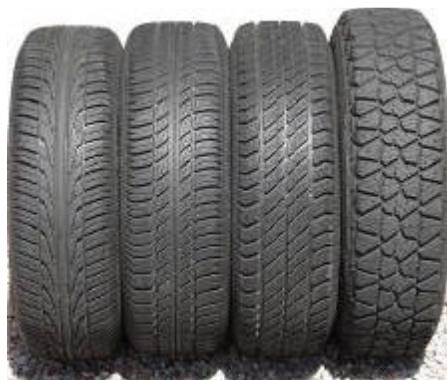
Slika 20: Primer različnih standardnih pnevmatik za izvajanje CPX meritev (Vir: FEHRL Report, 2006).
