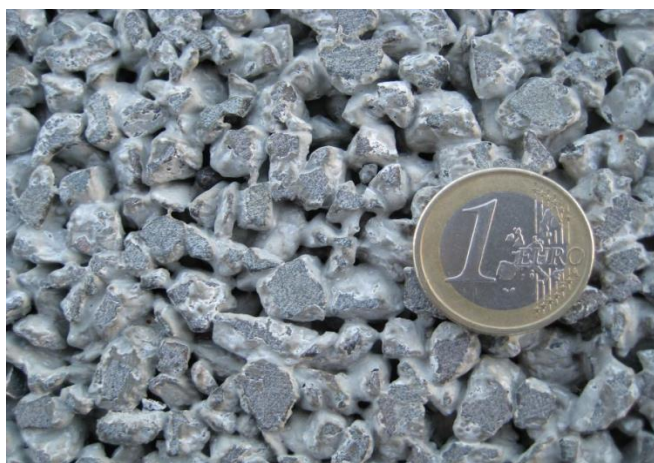
Slika 44: Drenažna cement betonska površina.
