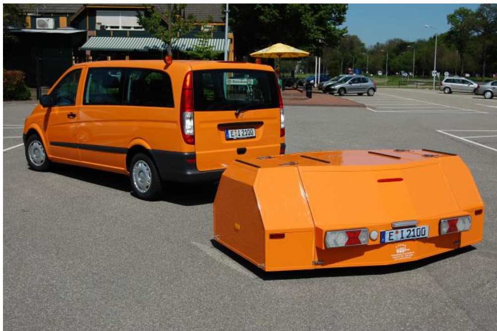
Slika 18: Primer merilne prikolice za izvajanje CPX meritev (vir: http://www.mplusp.eu/products/measuring-road-noise-go-comet-cpx , dne 21. 1. 2014).
