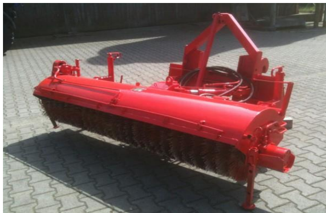
Slika 27: Primer priključka za Unimog, s katerim se izvede krtačenje betona.
