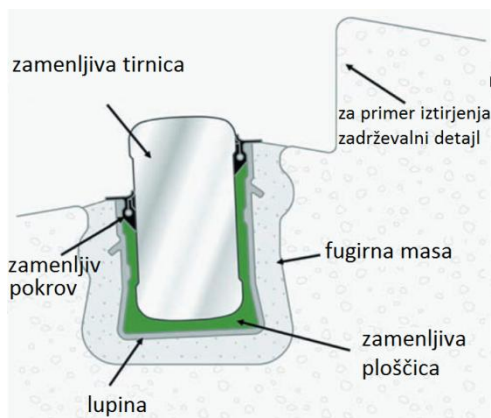
Slika 57: Sistem BBEST z vgrajeno tirnico (Vir: Esveld, 2003)
