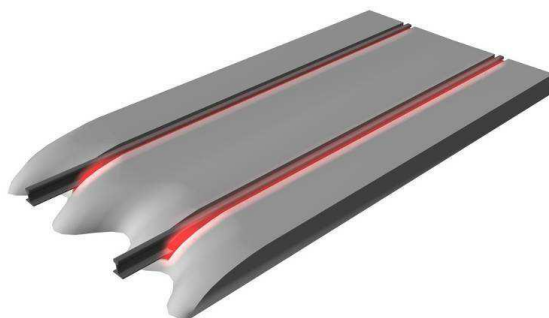
Slika 54: Shematski prikaz sistema z zvezno podprto in vgrajeno tirnico (Vir: http://conference.europoint.eu/highspeed2009/hubertrhomberg.pdf (20.7.2013))
