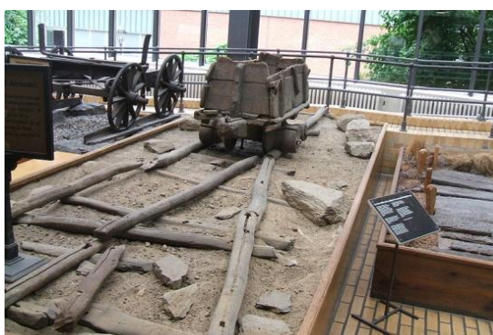
Slika 2: Odsek tira z okroglimi lesenimi tirnicami v Tehničnem muzeju v Berlinu (Vir: http://en.wikipedia.org/wiki/File:Round_timber_rails.jpg (3.10.2013))
