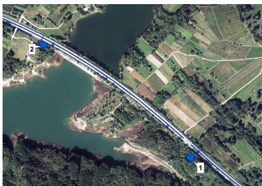
Slika 3: Shema cestne kanalizacije (modre črte) in zadrževalnika meteornih vod z lovilci olj (1 in 2) na območju zadrževalnika Vogršček (vir: DOF 2010, GURS; ZK GJL, GURS; izdelava slike: Matjaž Tratnik).
