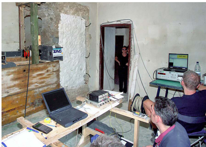
Slika 5.6: Strižni preizkus zidu
