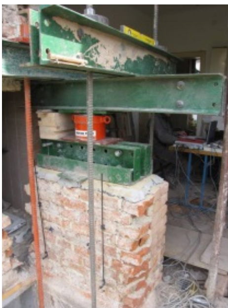
Slika 5.5: Tlačni preizkus zidu
