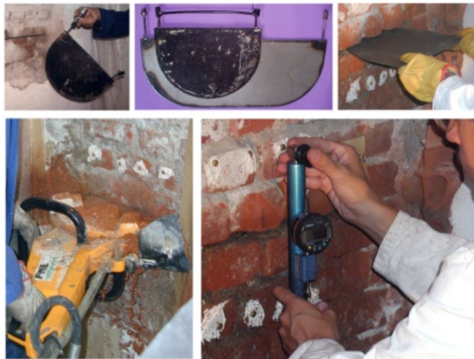
Slika 5.3: Potek preiskave z eno jekleno blazino
