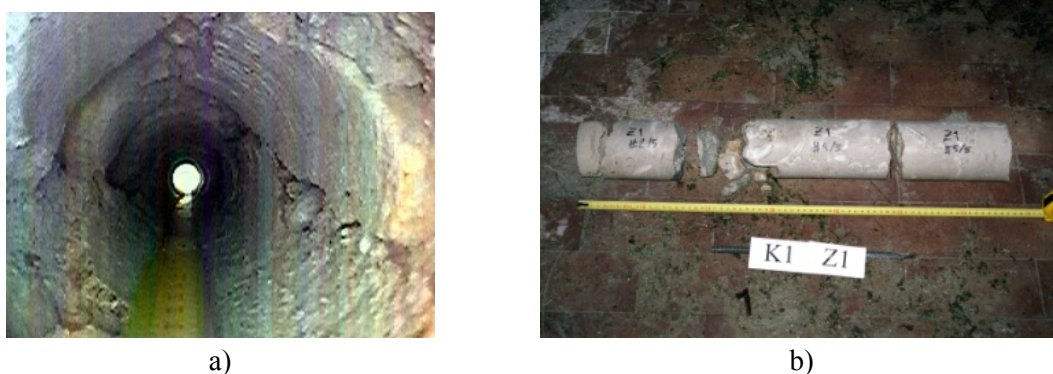
Slika 5.1: Rezultat sondiranja: a) pregled strukture zidu vzdolž celotne debeline in b) odvzem valjev kamnitih blokov, primernih za nadaljne preiskave v laboratoriju
