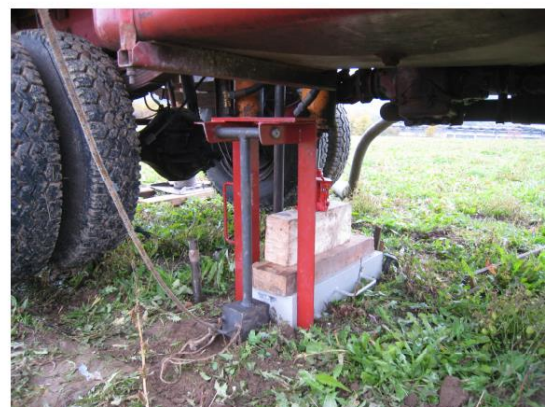
Slika 12: Potrebna oprema za izvedbo seizmičnega dilatometrijskega preizkusa in slika iz prakse (Logar, Robas, 2008)
