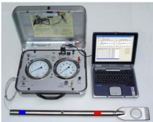
Slika 12: Potrebna oprema za izvedbo seizmičnega dilatometrijskega preizkusa in slika iz prakse (Logar, Robas, 2008)
