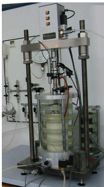
Slika 10: Vrednost \gamma_{0,7} je mogoče oceniti z »resonant column« testom (Žlender, 2003)
