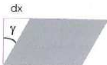
Slika 9: Deformirano telo zaradi delovanja strižne sile (Wallevik, 2009)
