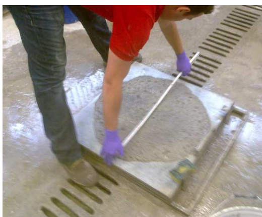
Slika 14: Merjenje razleza s posedom samozgoščevalnega betona
