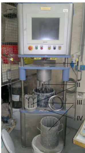
Slika 10: ConTec Viscometer 5 s pripadajočimi valji za preizkušanje betona in malte
