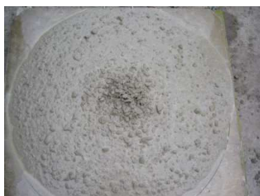
Slika 4: Segregacija SCC, test raleza s posedom
