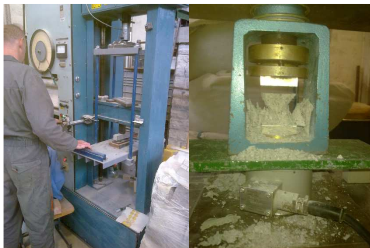
Slika 18: Upogibni in tlačni preizkus SCC malt
