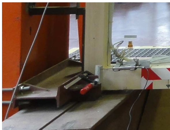
Slika 2.5 - Spodnja podpora (pridobljeno od Boštjana Bera)
