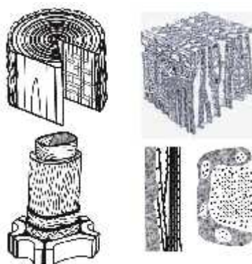
Slika 1.1 - Značilna kompozitna zgradba lesa na makroskopskem (zgoraj levo), mikroskopskem (zgoraj desno), sub-mikroskopskem (spodaj levo) in makro-molekularnem (spodaj desno) nivoju [7]
