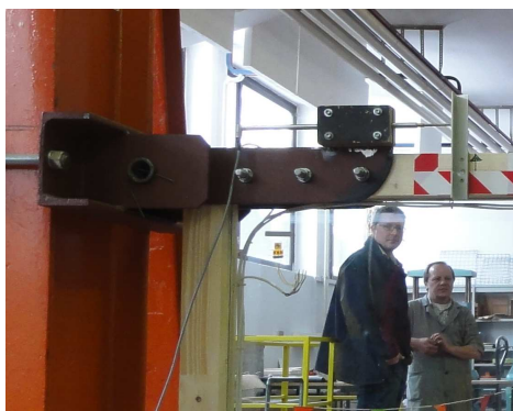
Slika 2.4 - Jeklena pločevina in trije vijaki preko katerih je panel vpet v jekleni okvir (pridobljeno od Boštjana Bera)
