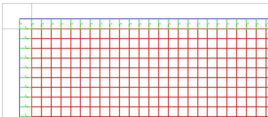
Slika 4.15 - Model konstrukcije za analizo v programu SAP2000. Vzmeti so podane tako, da je vozlišče i na težiščnici okvirja, vozlišče j pa na robu stekla.
