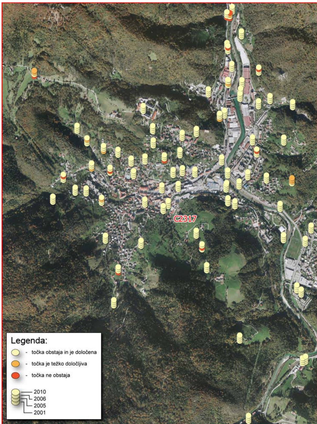
Slika 22: Stanje točk po serijah ortofota za list C2317 (podlaga slike: ortofoto; GURS, 2010b)
