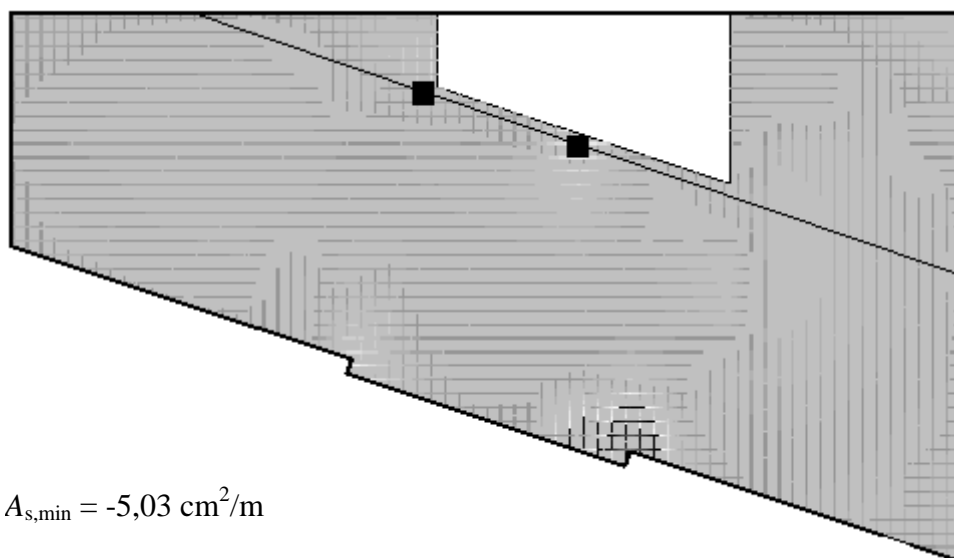
Slika 62: Zgornja armatura v plošči nad 1. Nadstropjem
