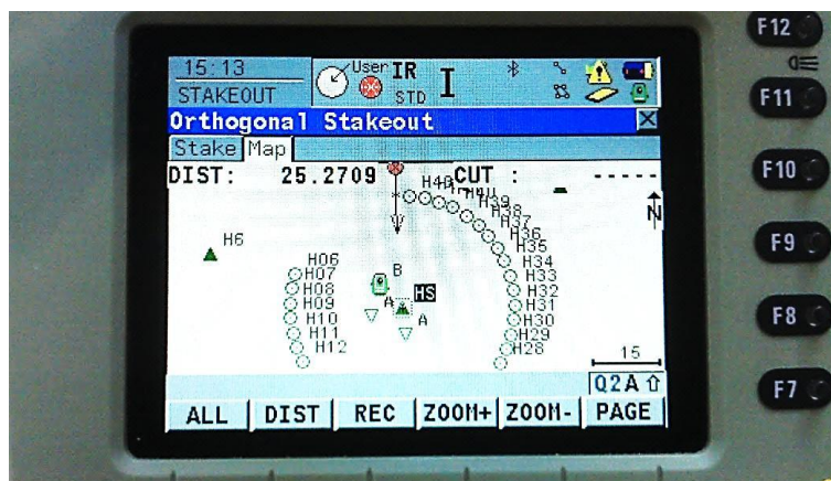
Slika 28: Zaslona instrumenta Leica TCRA 1201+ med zakoličevanjem (Rudis d.o.o., 2012)
