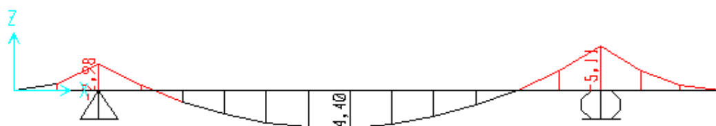
Slika 38: Ekstremni negativni moment nad podporama
