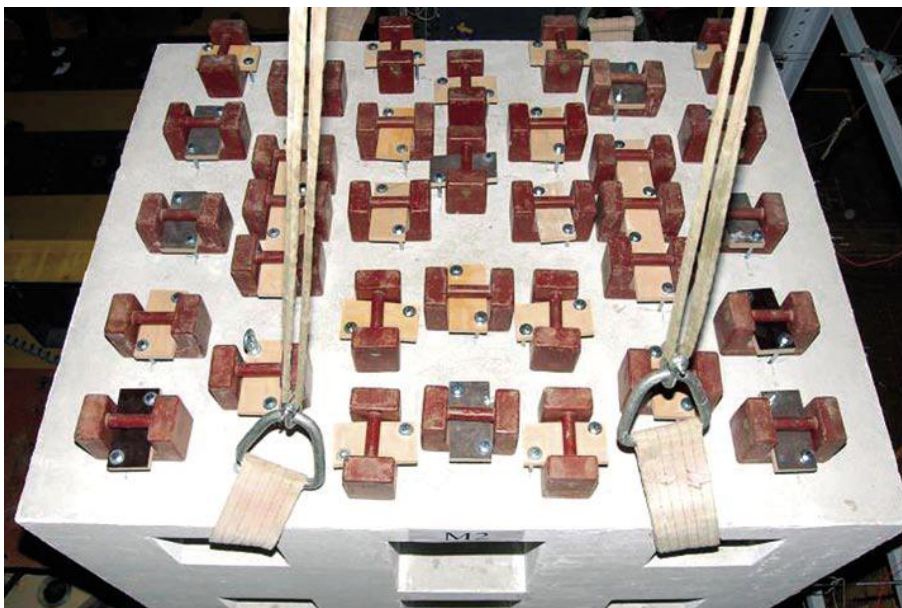
Slika 16: Dodatna masa, pritrjena na strešno ploščo modela M2 (ZAG, 2010)
