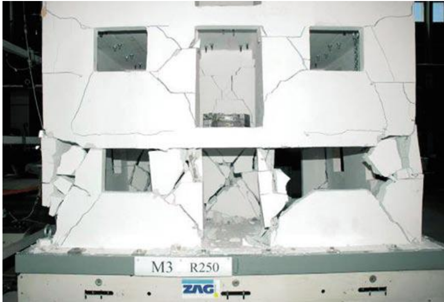
Slika 23: Tipične poškodbe zidov modela M3 po fazi preiskave R250 (ZAG, 2010)
