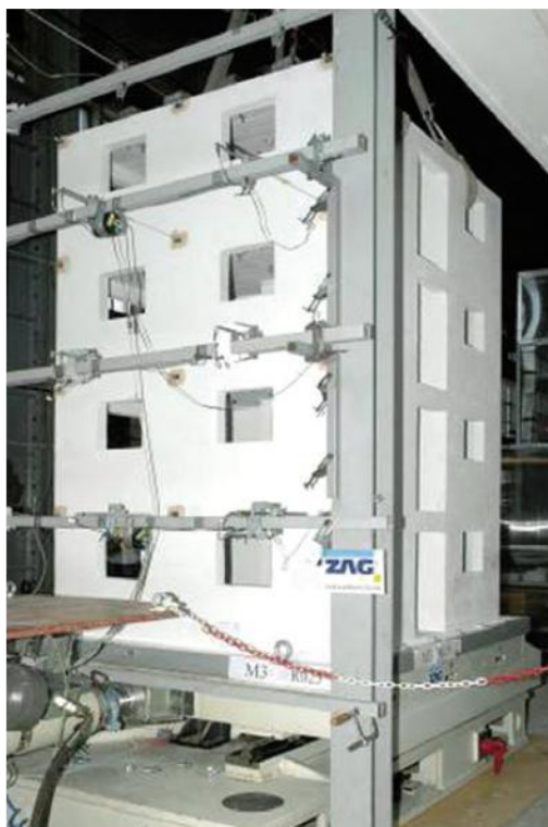
Slika 19: Postavitev modela M3 na potresni mizi in način pritrditve merilnih inštrumentov (ZAG, 2010)
