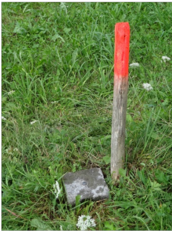
Slika 48: Stabilizacija in mikrolokacija točke Brdo. Figure 48: Ground marker and micro-location of the point Brdo.
