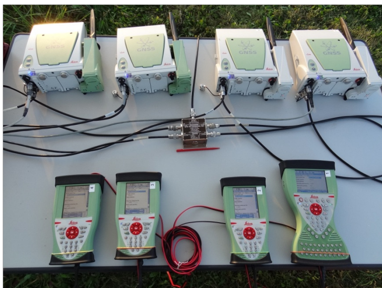
Slika 25: Merska oprema med izvajanjem meritev. Na sredini je viden antenski delilnik.
