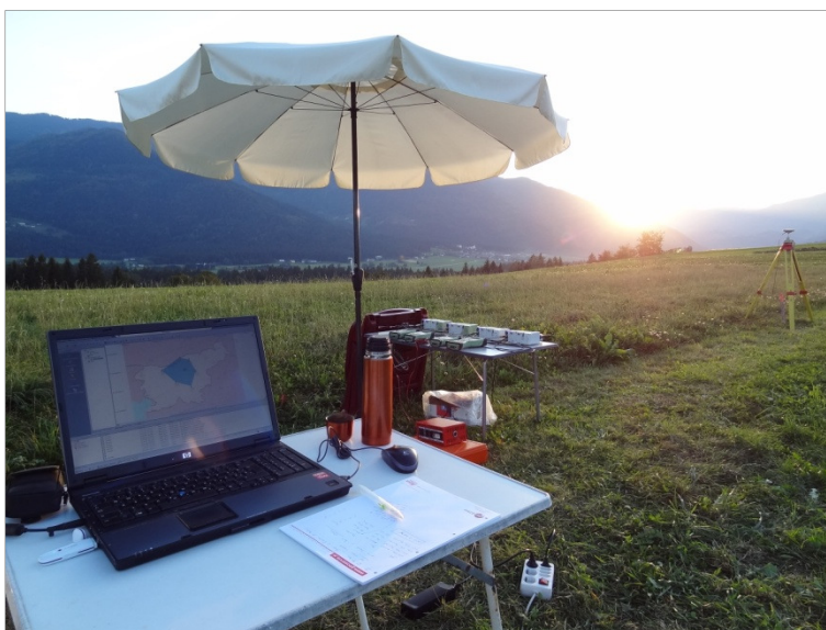
Slika 89: Daljinski dostop do programske opreme Leica GNSS Spider je med terensko izmero omogočal takojšnje diagnosticiranje morebitnih težav.
