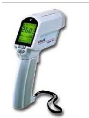
Slika 14: Merilna pištola Raynger MX s katero sem izmeril temperature obodnih površin.
