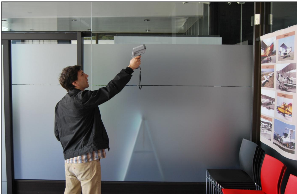
Slika 9: Merjenje sevalne temperature skladno s standardom SIST EN ISO 7726:2002 [24].
