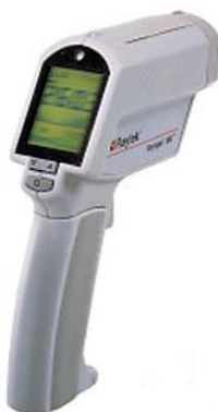
Slika 17: Merilni inštrument Raytek Raynger MX
