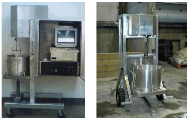
Slika 14: IBB reometer, desno prenosna verzija (Ferraris in Brower, 2001).
