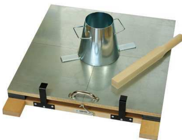
Slika 34: Oprema za preskus razleza ( http://www.reliancelab.co.za/concrete-flow-table/ ).
