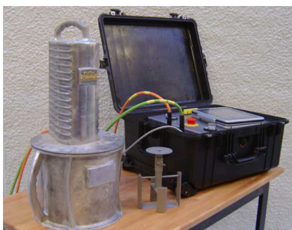
Slika 15: ConTec Rheometer-4SCC (Wallevik, 2009b).
