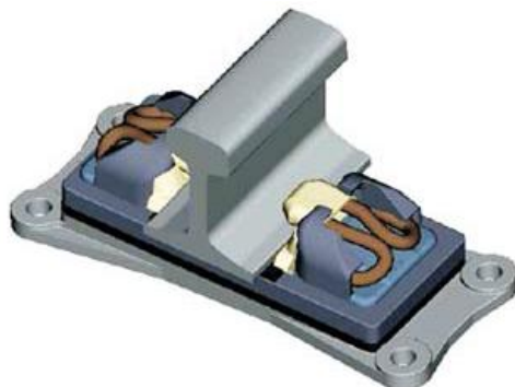
Slika 34: Elastični predhodno obremenjeni pritrdilni pribor [7]
