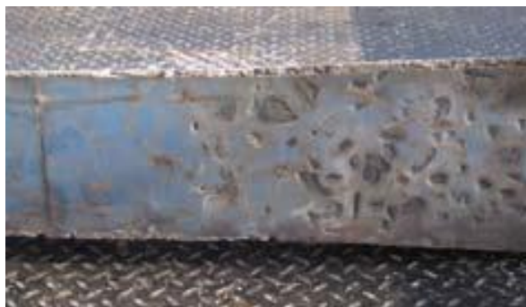
Slika 42: Stanje podplata po 190 milijonov prevoženih tonah [36]
