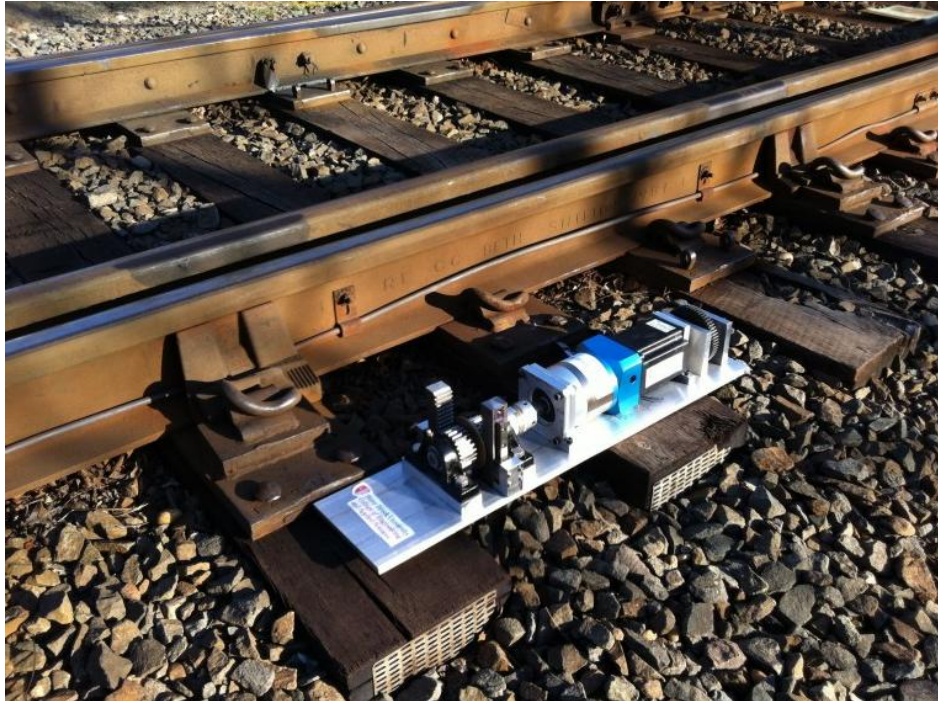
Slika 28: Naprava za pridobivanje električne energije iz vibracij [32]
