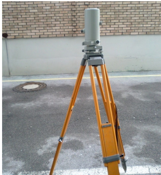
Slika 2: Zenitlot Carl-Zeiss PZL 100
