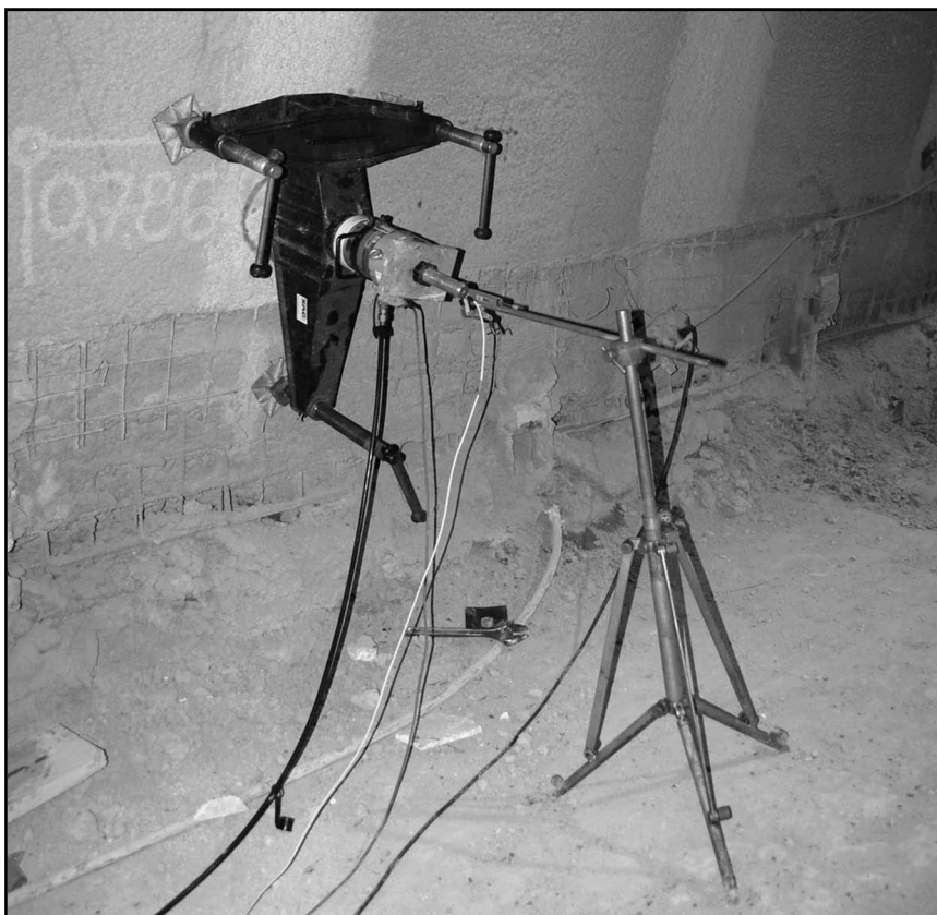
Slika 19: Primer sistema za izvedbo izvlečnih preskusov (Zavod za gradbeništvo Slovenije)
