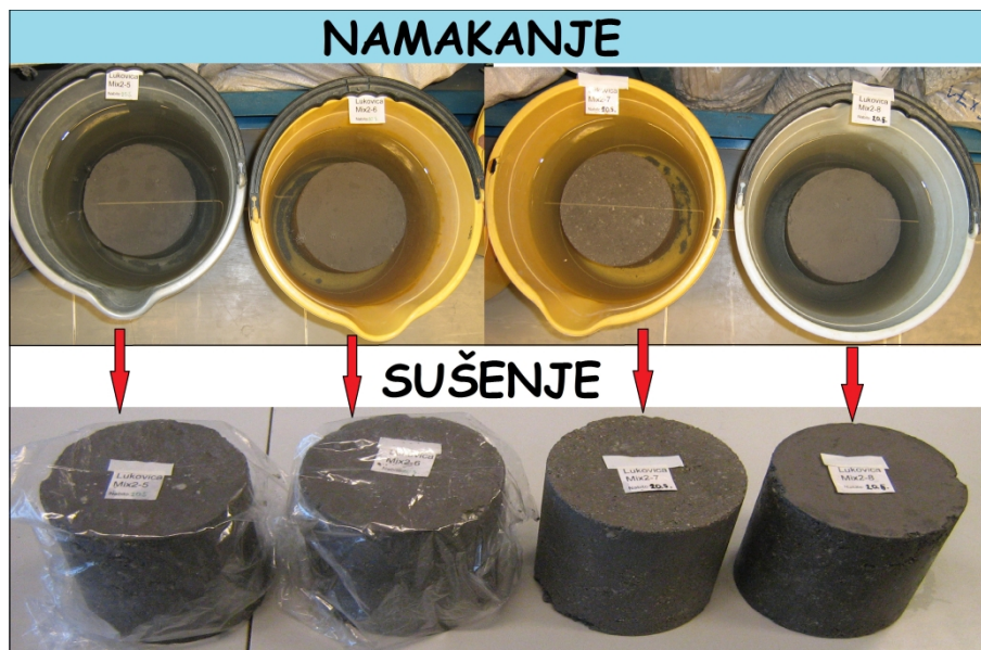
Slika 4: Vzorci, izpostavljeni 12 ciklom namakanja in sušenja
