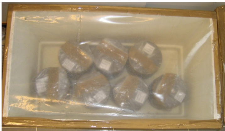
Slika 1: Vzorce, zaviti v folijo in položeni v zatesnjeno komoro
