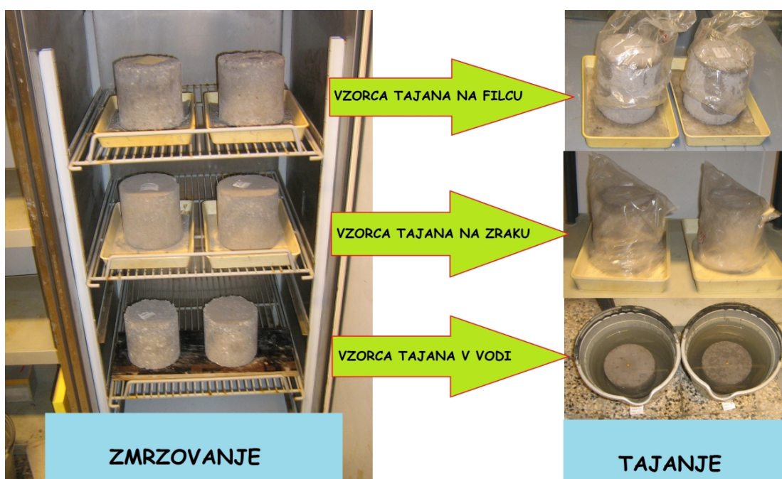
Slika 3: Vzorci, izpostavljeni 12 ciklom zmrzovanja in tajanja
