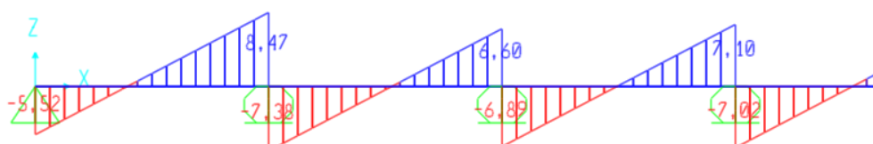
Slika 21: Diagram prečnih sil [kN] za komb. K1
