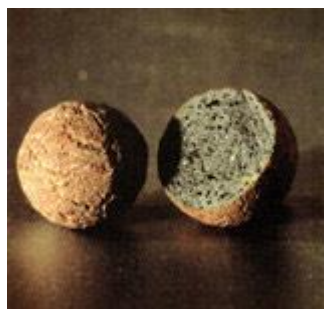
Slika 15: Glinena kroglica lahkega agregata-Liapor ( http://www.meier-baustoffe.de/liapor-grundstoff.html )
