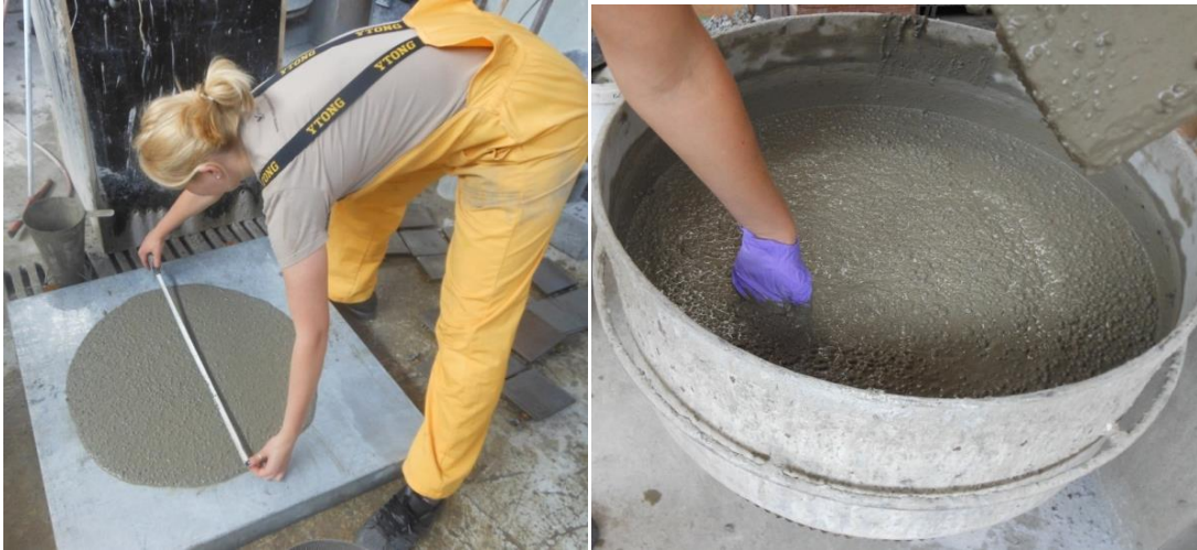
Slika 18: Standardni preizkus razleza s posedom in ugotavljanje segregacije s fizičnim dotikom in vizualno oceno betonske mešanice
