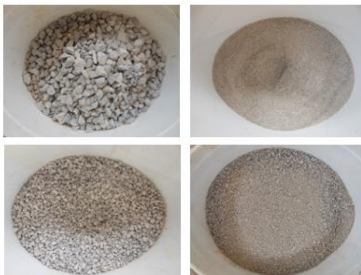
Slika 33: Uporabljen agregat za preizkušanca SCC in SCC-s
