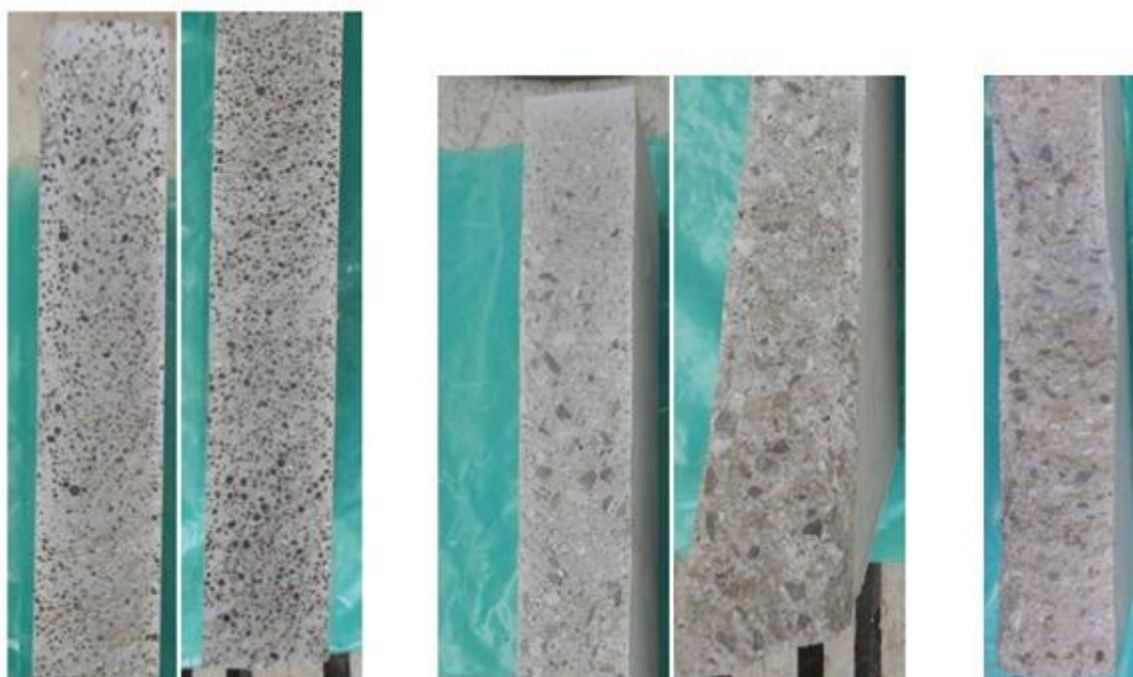
Slika 52: Zgornji in spodnji del preizkušanca LDSCC-s, zgornji in spodnji del preizkušanca SCC-s ter spodnji del preizkušanca SCC
