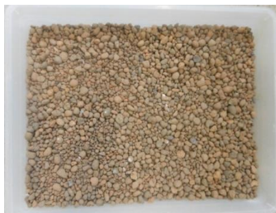
Slika 28: Uporabljen agregat iz ekspandirane gline –Liapor
