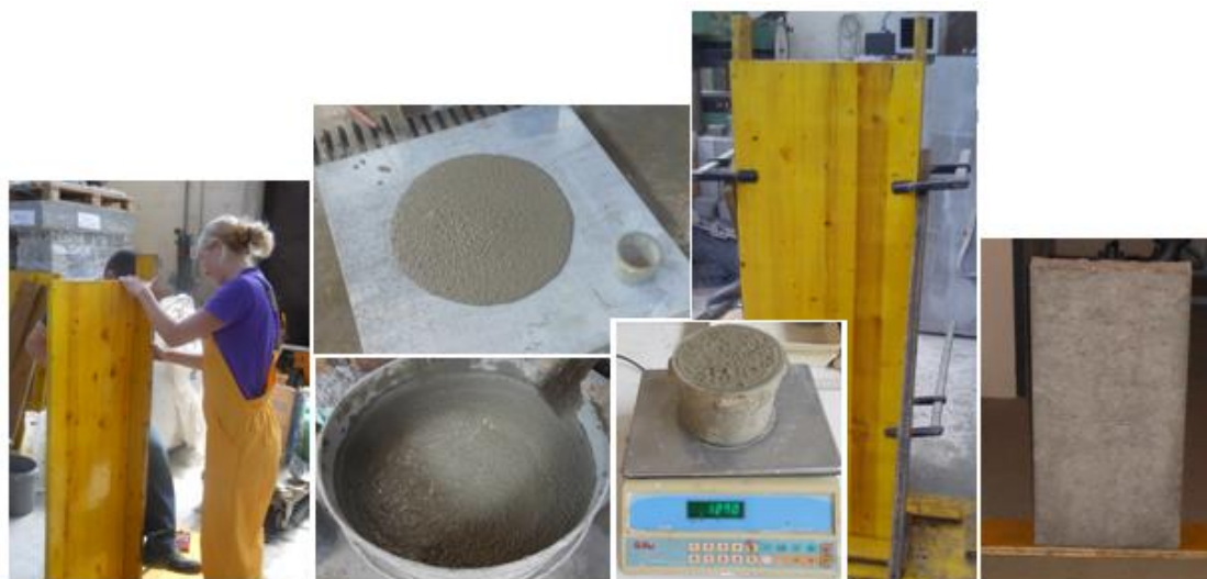
Slika 32: Potek izdelave betonskega preizkušanca
