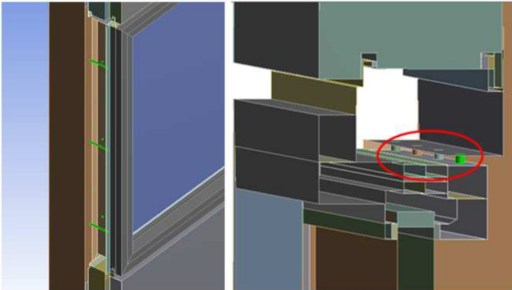
Slika 21: Vijačenje okenskega okvirja na nosilec okenske odprtine
