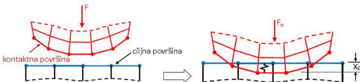
Slika 84: Formiranje stika po metodi »Augmented Lagrange«
