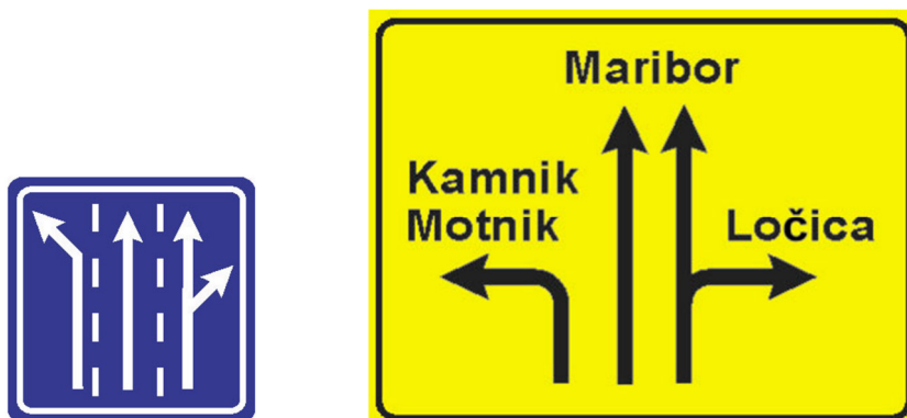
Slika 9: Prometni znak za razvrščanje vozil (III-85) in znak za razvrščanje vozil z imeni krajev (III-85.1) (vir: PPSPO, 2000)
