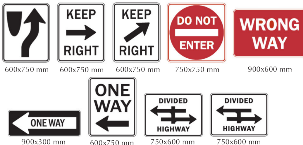
Slika 31: Minimalne velikosti tabel za preprečevanje vožnje v napačno smer. ([32]: str. 2)
