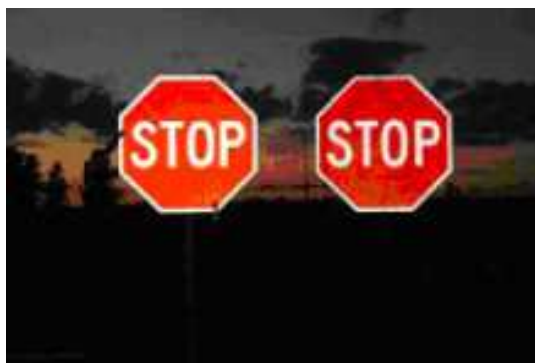
Slika 20: Primerjava kvalitete retrorefleksije prometnih znakov iz različnih folij. [41]
