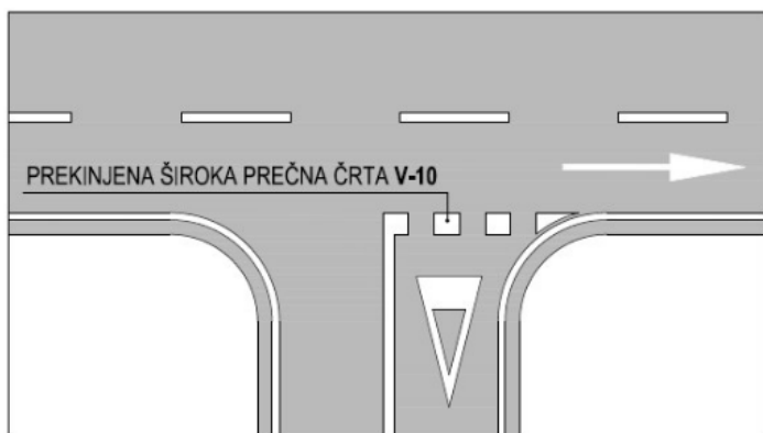
Slika 81: Prekinjena široka prečna črta (V-10) in opozorilni trikotnik (V-39.2). ([47]: str. 55)
