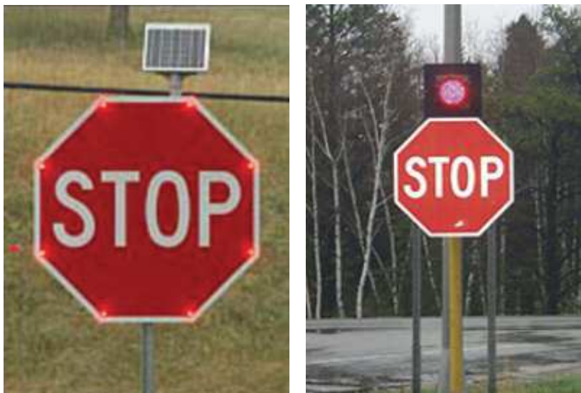
Slika 21 in Slika 22: Vizualni poudarki prometnih znakov z LED-diodami in lučmi. ([3]: str. 172), ([39]: str. 9)
