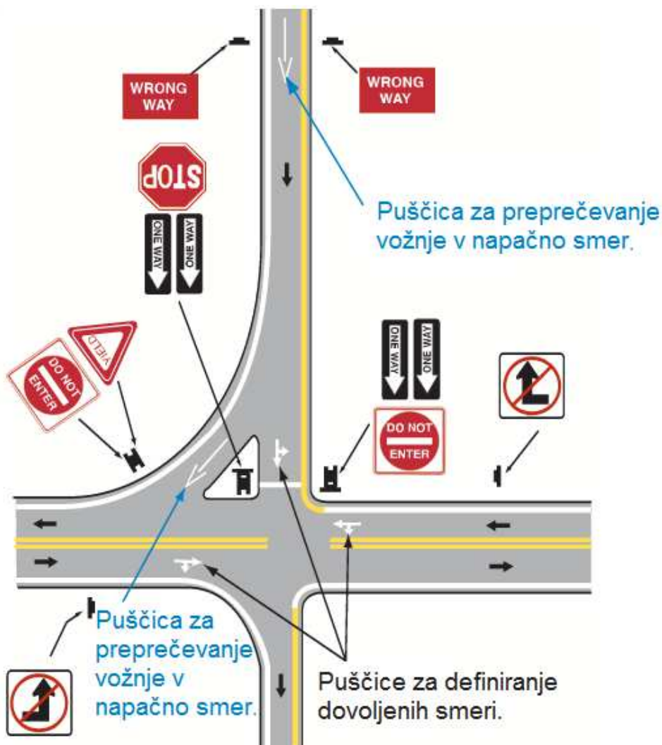
Slika 47: Uporaba puščic za preprečevanje vožnje v napačno smer. ([32]: str. 19)
