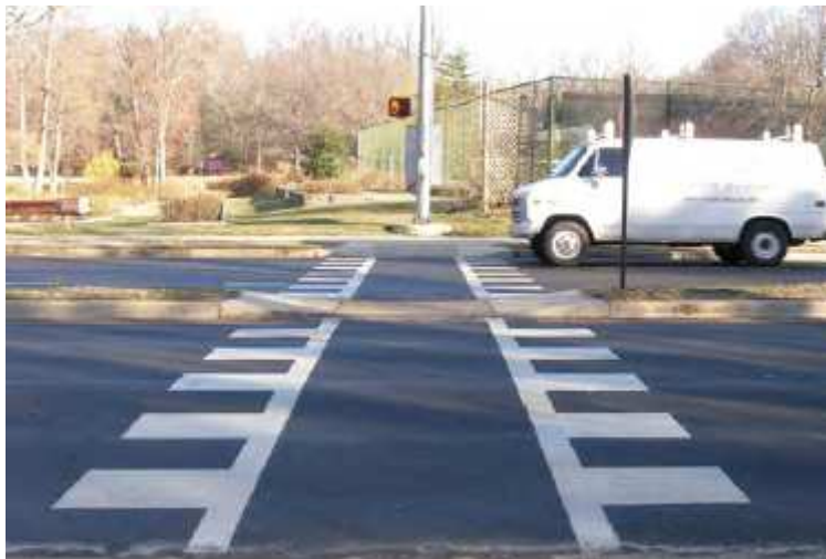
Slika 68: Kombinacija zebre in paralelnih črt. ([29]: str. 43)
