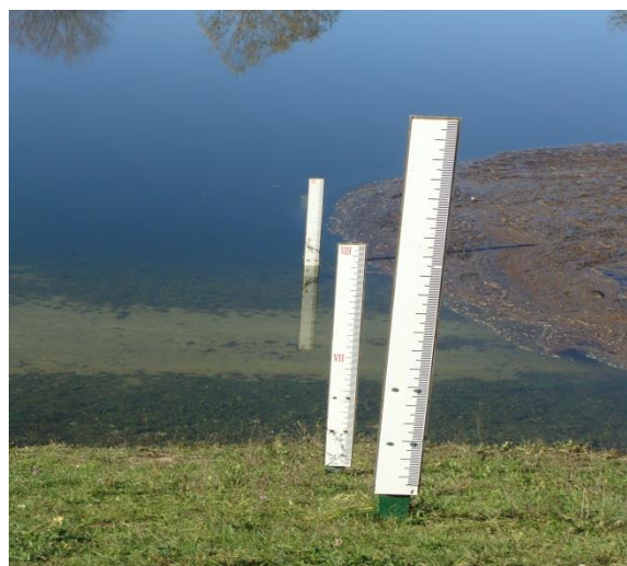
Slika 5: Mersko mesto nivoja gladine v zadrževalniku (foto: Mušič, 2012)
