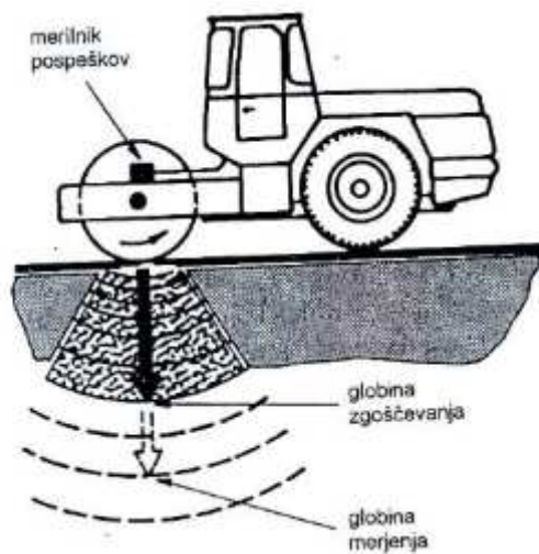
Slika 39: Merilni valjar s sistemom za kontinuirano kontrolo zgoščanja (TSC 06.713, 2005: str. 8)
