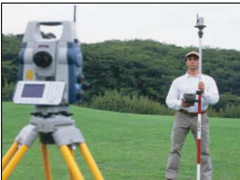
Slika 12: Izmera z TPS-sistemom proizvajalca Sokkia (vir: http://www.sokkia.com/Products/Detail/SRX.aspx )
