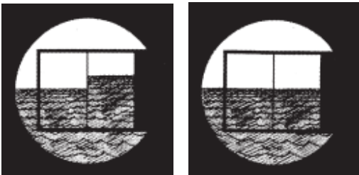
Slika 6: Primer z indeksnim pogreškom (leva slika) sekstanta in brez (desna slika),
