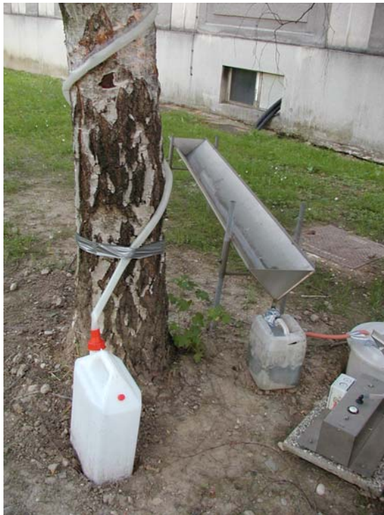
Slika 4. Merjenje odtoka po deblu (levo breza, desno bor) / Stemflow measurement (left Betula pendula, right Pinus sylvestris).
