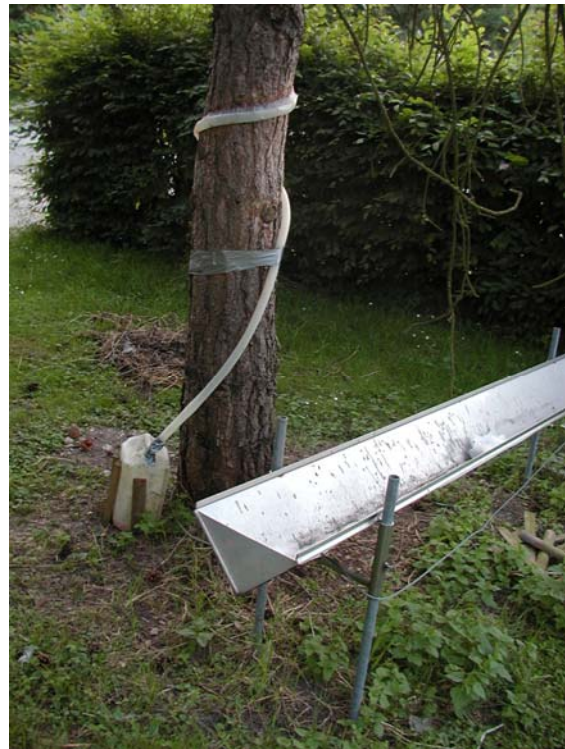
Slika 4. Merjenje odtoka po deblu (levo breza, desno bor) / Stemflow measurement (left Betula pendula, right Pinus sylvestris).
