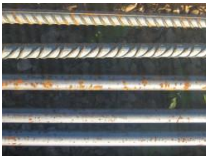
Slika 12: Jeklo za armiranje betona, rebrasta in gladka armatura (Železokrivstvo Rakanovič, 2013)
