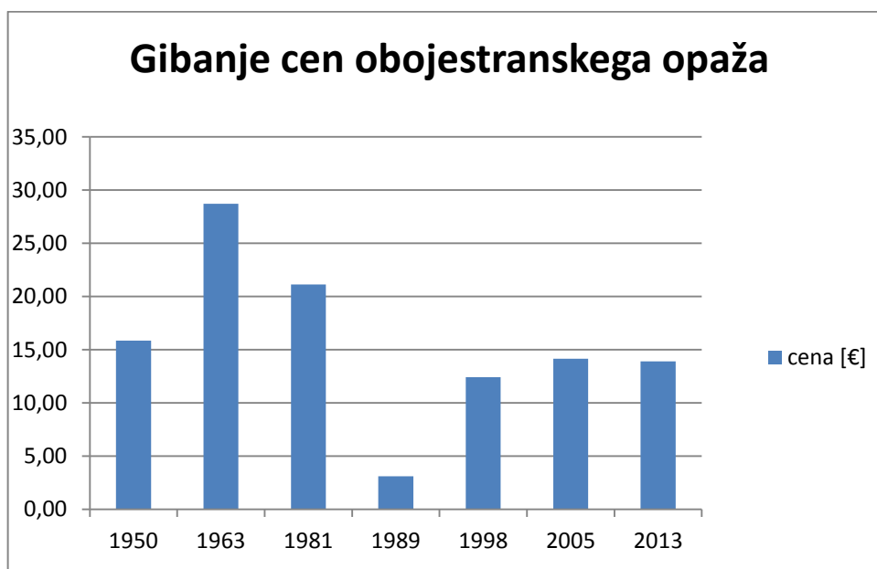
Grafikon 3: Gibanje cen obojestranskega opaža v različnih časovnih obdobjih, preračunane na dan 1. 1. 2013. Cene veljajo za postavitev 1 m 2 opaža
