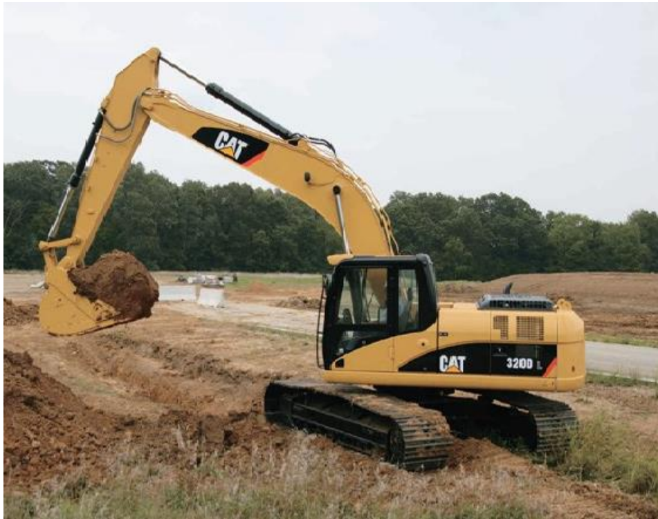
Slika 14: Bager goseničar z močjo 115 KW ( New earthmovers, 2013)
