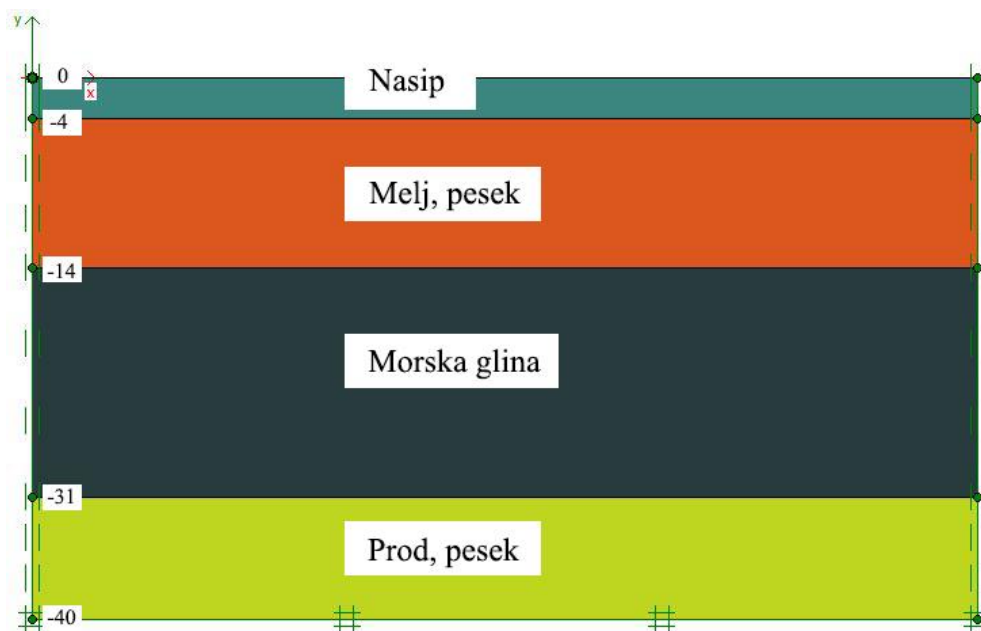
Slika 41: Prerez temeljnih tal na pomolu 2, model v programu Plaxis.
