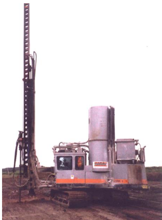
Slika 11: Silos, kompresor in sušilec na mešalnem stroju (EuroSoilStab, 2002: str. 62).
