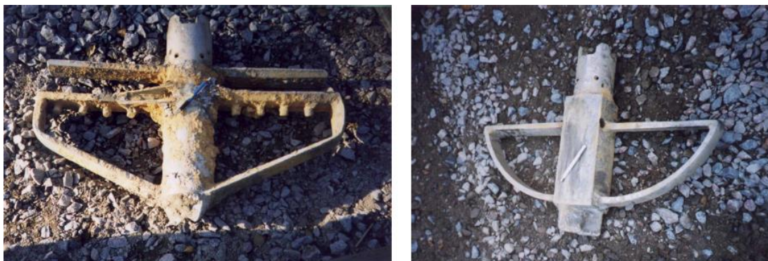
Slika 14: Mešalke za suho mešanje (EuroSoilStab, 2002: str. 65).
