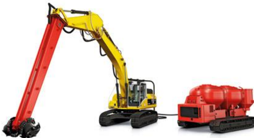
Slika 18: Mehanizacija za izvedbo površinskega mešanja ( http://s3.thingpic.com/images/D1/iXwa4me5LjcrkPYDaAdz.jpeg ).
