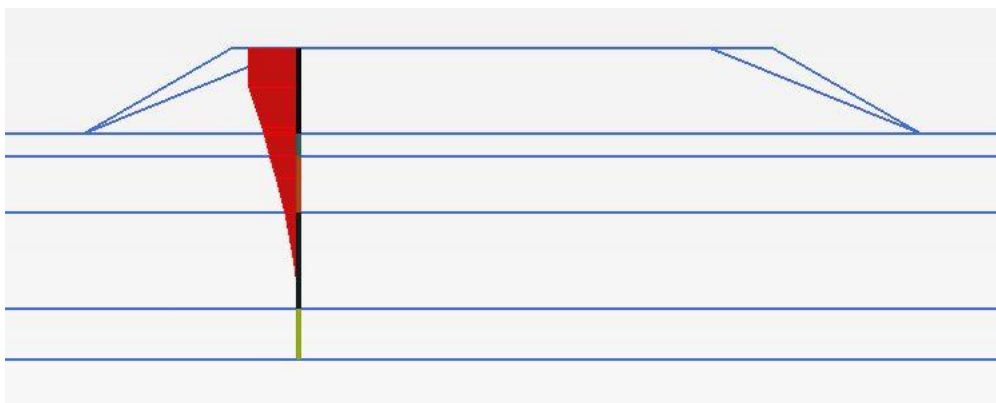
Slika 39: Diagram vertikalnih pomikov v osi največjih deformacij, model Hardening Soil.
