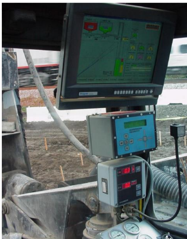
Slika 20: Kontrolna enota s prikazovalnikom in instrumenti za uravnavanje parametrov mešanja (EuroSoilStab, 2002: str. 87).
