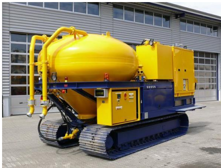
Slika 12: Ločen obrat za mešanje in črpanje veziva ( http://www.kellergrundbau.com ).
