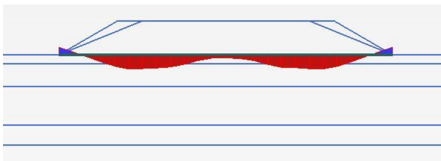
Slika 37: Diagram vertikalnih pomikov na nivoju temeljnih tal, model Hardening soil; max 31 cm.
