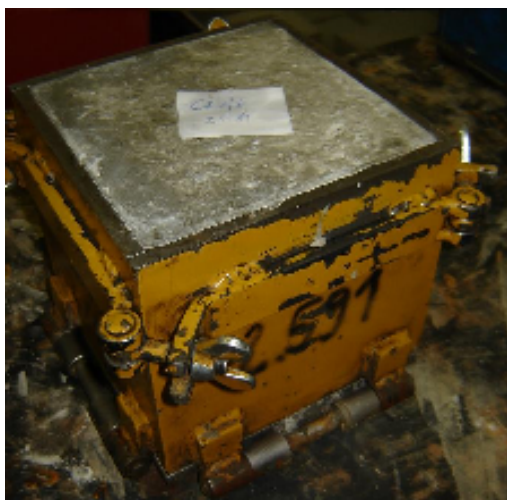
Slika 22: Kalup z strjenim betonom pred odstranitvijo kalupa.
