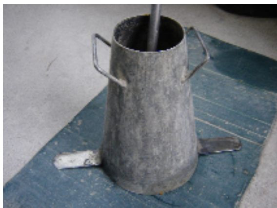
Slika 11: Naprava določitev poseda in razleza.
