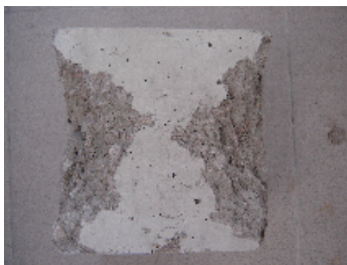
Slika 28: Primer pravilne porušitve preizkušanca.
