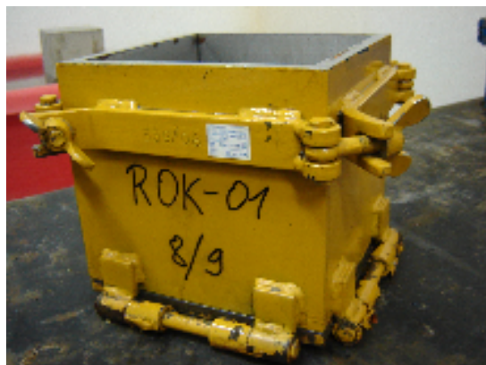
Slika 19: Kalup kocke 150x150x150 mm.
