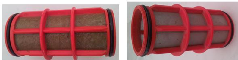
Slika 25: Sitast 0,13 mm filter po in pred testiranjem
