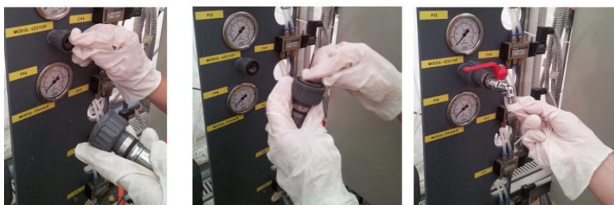
Slika 29: Dezinfekcija vzorčne pipice za odvzem filtrata UF
