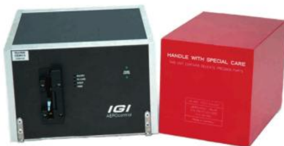
Slika 11: IMU enota ter računalnik za sistem Aerocontrol (AeroControl - IGI).
