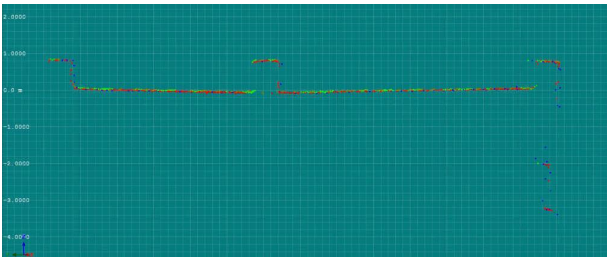
Slika 32: Prikaz točk različnih snemalnih pasov na primeru višjih stavbah po upoštevanih parametrih kalibracije.
