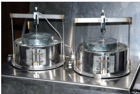
Slika 16: Aparat za določanje volumske stabilnosti zrn črne jeklarske žlindre (Vir: [40])
