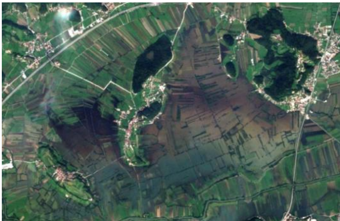
Slika 19: Radiometrična nehomogenost poplavljenih površin na barvnem satelitskem posnetku RapidEye. Poleg značilne modrozeleno barve so poplavljene površine obarvane tudi s temnejšimi rjavimi in črnimi barvnimi odtenki.
