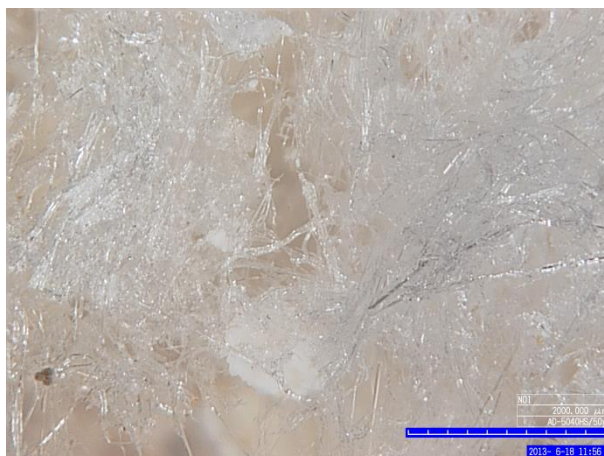
Slika 58: Nitasta kristalizacija soli na merilnem mestu 7.
