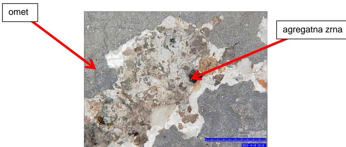
Slika 43: Omet na merilnem mestu 2. Iz slike je lepo razvidna sestava ometa ter velikost agregatnih zrn, ki ne presegajo velikosti 2 mm.
