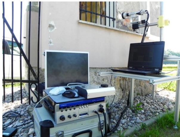
Slika 34: Sistem HIROX (HIROX KH-3000-LCD 3D, uporabljen za mikroskopiranje.
