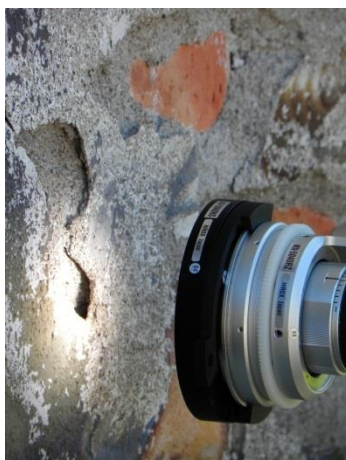
Slika 38: Fotografija prvega merilnega mesta na kapelici na Visokem pri Kranju (nabrekanje ometa).
