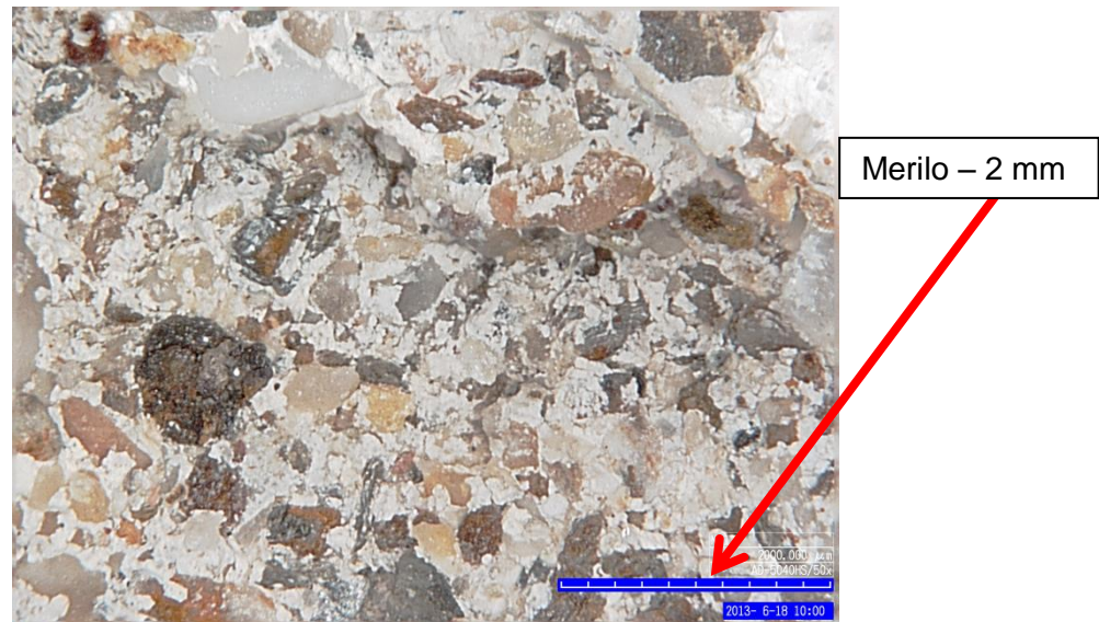
Slika 40: Omet na merilnem mestu 1. S slike sta lepo razvidni sestava ometa in velikost agregatnih zrn, ki ne presegajo velikosti 2 mm.
