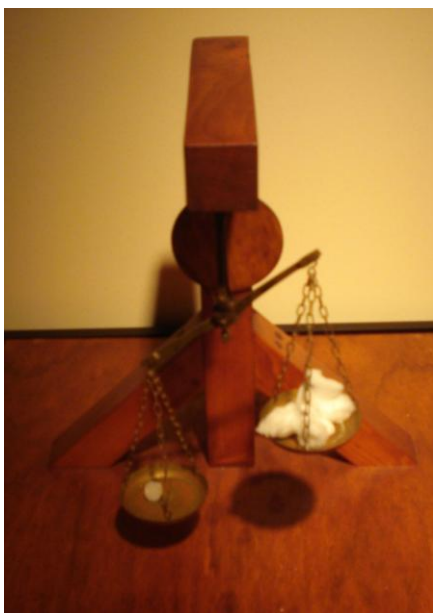
Slika 16: Model hidrometra, kakršnega je uporabljal Leonardo (foto: Rok Goltnik)
