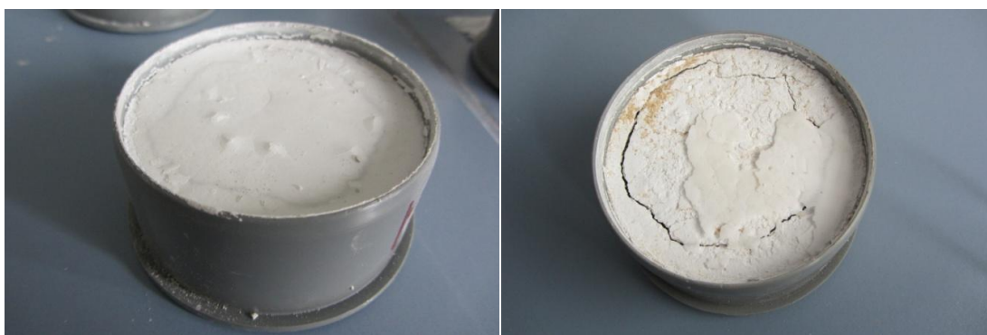
Slika 8: Injekcijska masa C2: Izrazito krčenje (levo) in vidna razpokanost po merjenju krčenja (desno)
