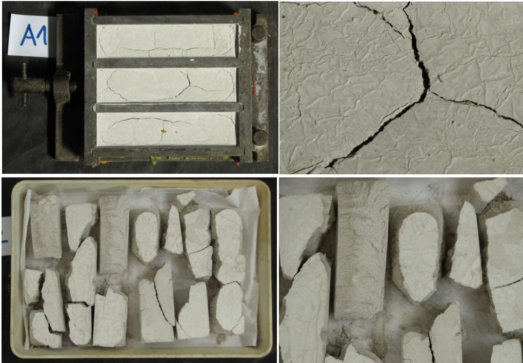
Slika 9: Razpokanost injekcijske mešanice A1(52) v prizmi (zgoraj) in razpadli vzorci mešanice A3(33) po razkalupljenju (spodaj)
