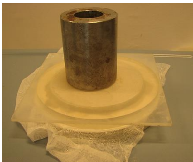
Slika 4: Test vodozadržnosti: obtežen kalup
