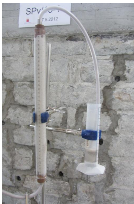
Slika 13: Injektiranje mešanice A1(52) skozi omočen drobljen omet
