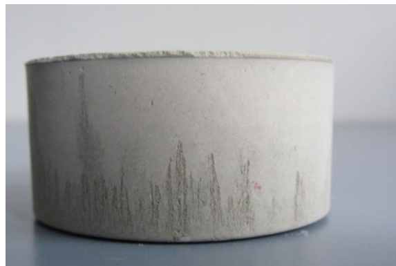
Slika 10: Vidna segregacija cementa na strjenem vzorcu injekcijske mešanice D3
