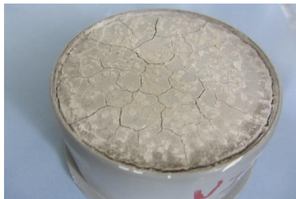
Slika 11: Razpokanost apneno cementne injekcijske mešanice
