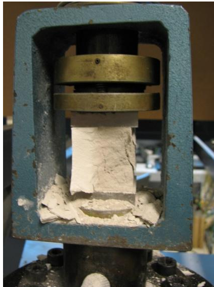
Slika 5: Preizkus tlačne trdnosti
