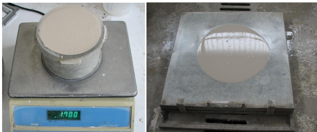
Slika 3: Določanje prostorninske mase (levo) in razleza (desno)
