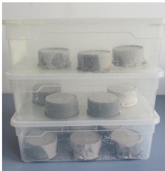
Slika 6: Apnene injekcijske mase v komori
