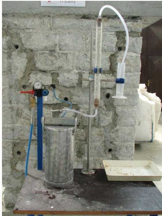
Slika 12: Naprava za preizkus sposobnosti injektiranja, v ozadju injektiran kamnit zid
