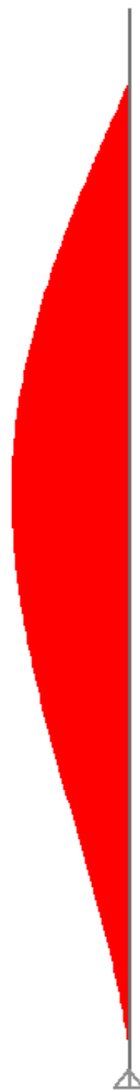
Slika 11: Diagram upogibnih momentov v konstrukciji ( M_{\max} = 3111 kNm/m)
