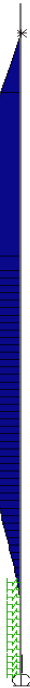
Slika 15: Diagram upogibnih momentov v konstrukciji - izračun z Winklerjevimi vzmetmi ( M_{\max} = 3080 \text{ kNm/m} )
