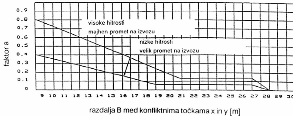
Slika 9: Diagram za določitev faktorja \alpha (TSC 03.341, 2012, str.17)
