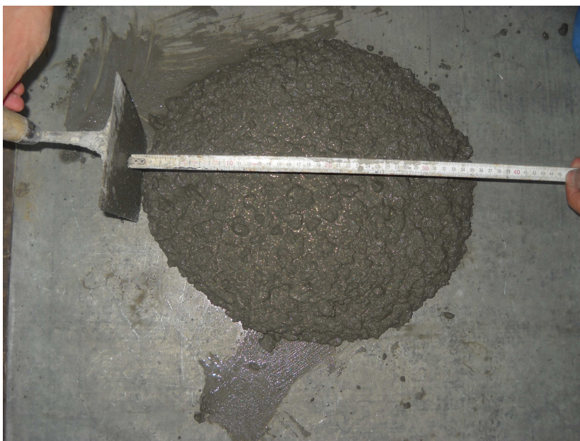
Slika 13: Merjenje razleza svežega betona
