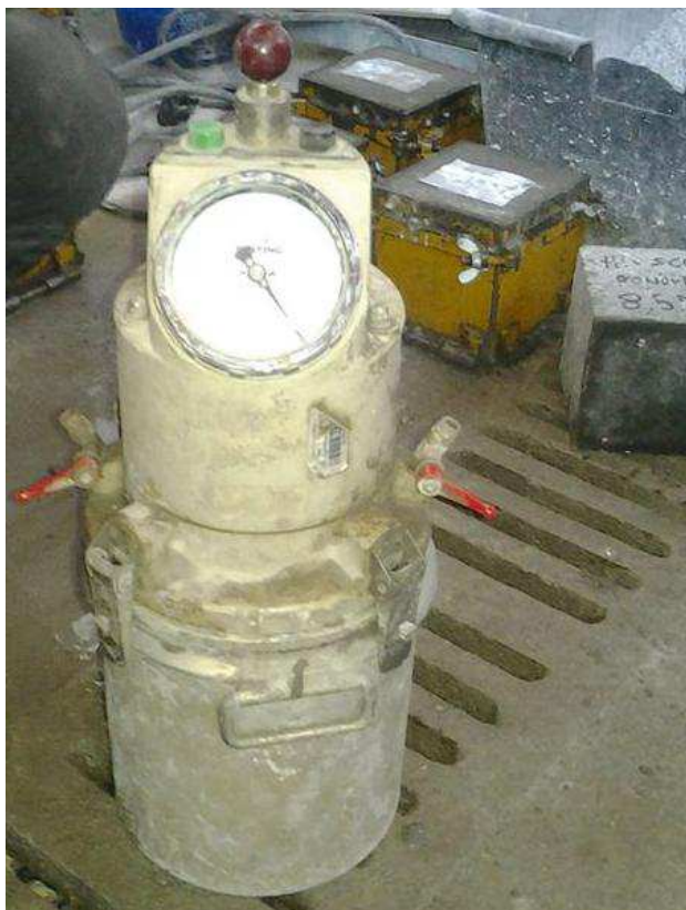
Slika 14: Naprava za merjenje vsebnosti zraka v svežem betonu
