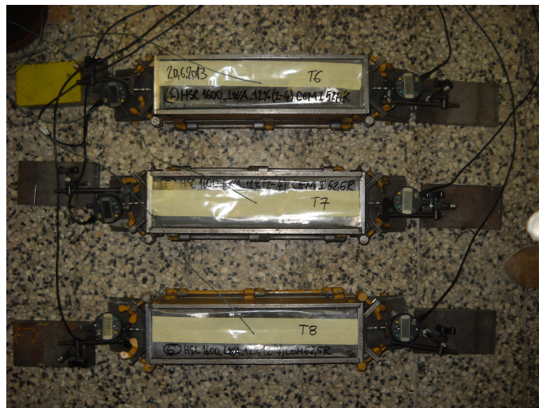
Slika 16: Elektronsko merjenje avtogenega krčenja preskušancev
