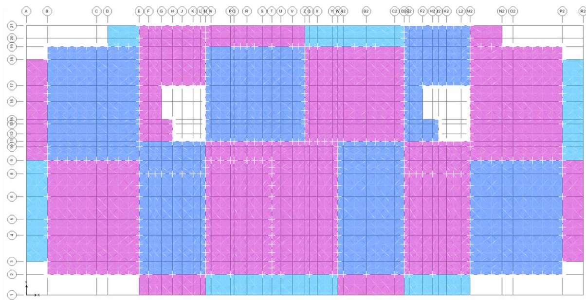
Slika 22: Šahovska razporeditev koristne obtežbe po površini plošče
