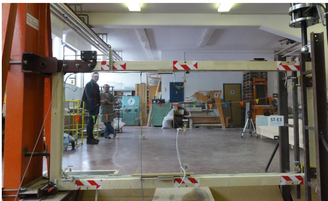
Slika 1: leseno stekleni panel med preskusom (fotografija je pridobljena od B. Bera)
