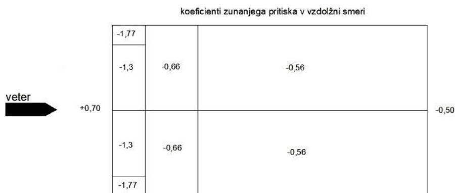
Slika 7: Koeficienti zunanega pritiska v vzdolžni smeri
