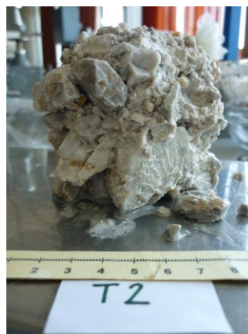
Slika 5.49: Viden je del votlih prostorov v vzorcu T2 na koncu raziskave
