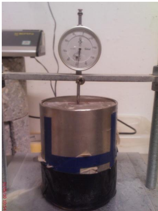
Slika 4.8: Merjenje deformacij na vzorcu pri cikličnem zmrzovanju
