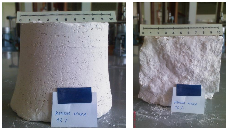
Slika 5.4: Zunanja in notranja tekstura vzorca KM 13% na koncu raziskave
