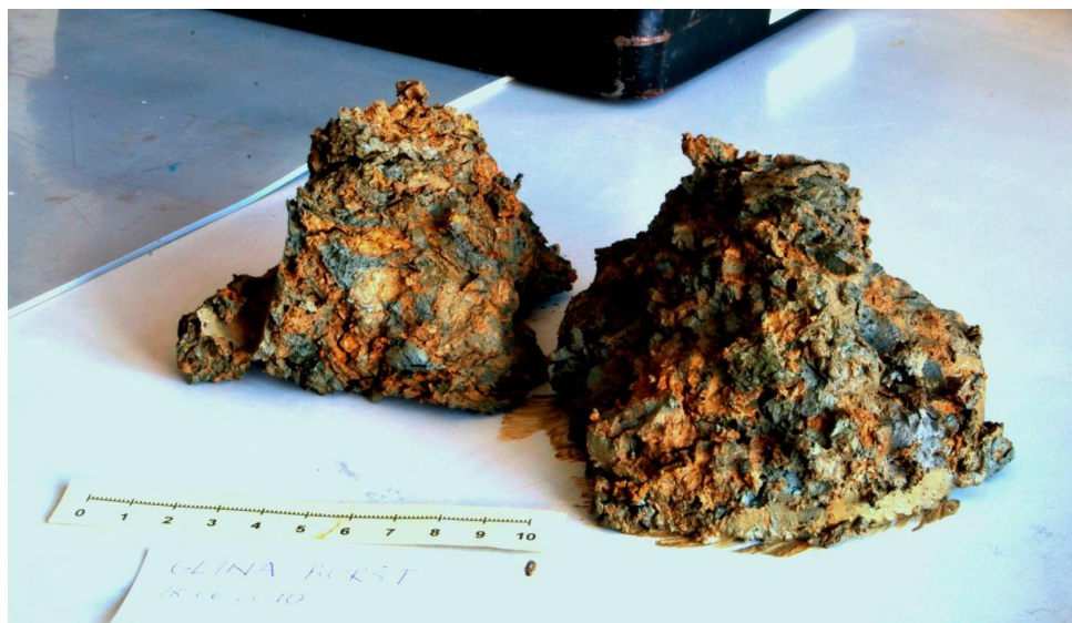
Slika 5.15: Glina Boršt po koncu preiskave cikličnega zmrzovanja in tavanja
