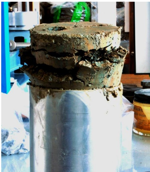
Slika 5.14: Deformacija gline Boršt ob iztiskanju iz valja
