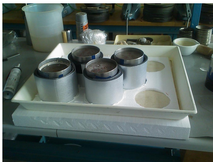
Slika 4.6: Prikaz toplotne izolacije vzorcev
