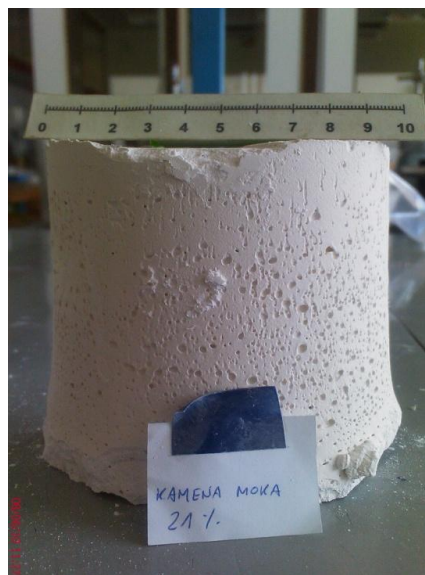
Slika 5.9: Zunanja tekstura vzorca KM 21% po končanih raziskavah
