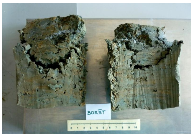
Slika 5.32: Vidne so razpoke in nastanek ledenih leč zgoraj na glini Boršt
