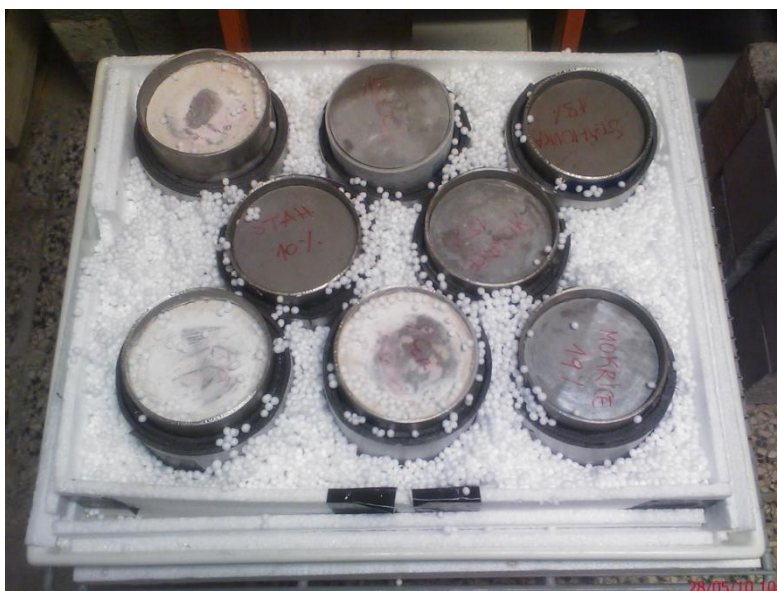
Slika 4.9: Vzorci med preiskavo cikličnega zmrzovanja in tajanja
