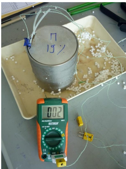
Slika 4.14: Merjenje temperature na treh različnih višinah (slojih) v vzorcu
