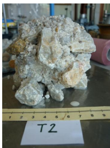
Slika 5.49: Viden je del votlih prostorov v vzorcu T2 na koncu raziskave
