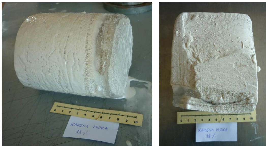
Slika 5.27: Vidne so ledene leče v spodnjem delu vzorca KM 13%
