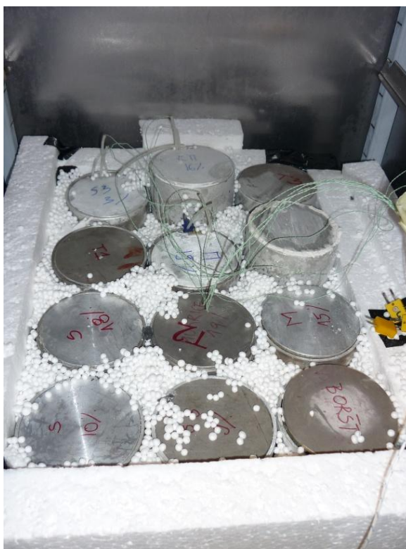
Slika 4.11: Vzorci v zamrzovalniku med zmrzovanjem z odprtim sistemom
