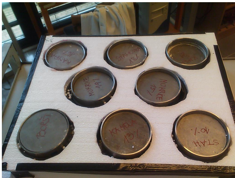
Slika 4.5: Pripravljene vzorce za preizkus cikličnega zmrzovanja in tavanja
