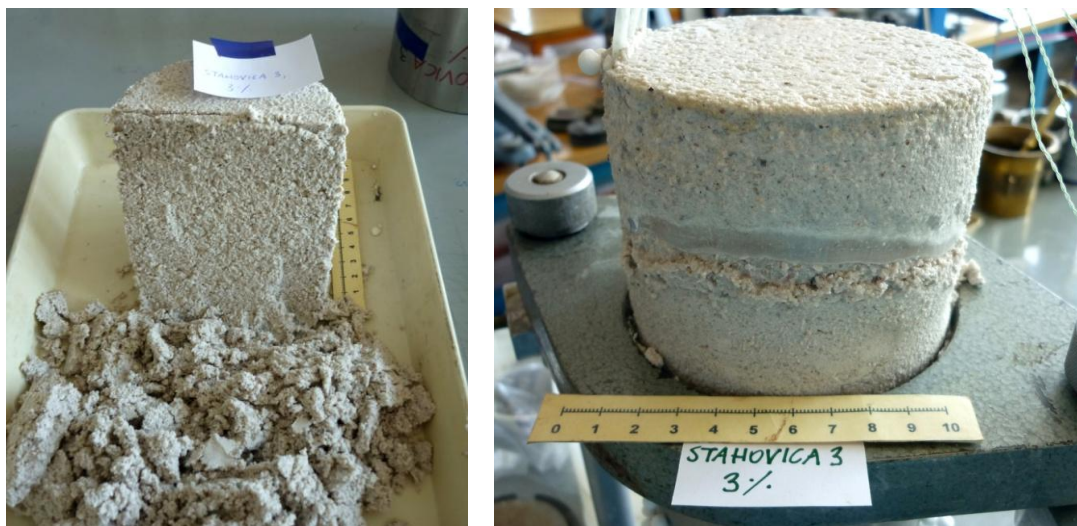
Slika 5.45: Vidna je ledena leča v srednjem zunanem delu vzorca S3 3%
