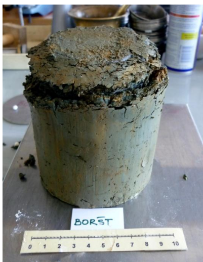
Slika 5.31: Vidna je deformacija na glini Boršt v zgornjem delu
