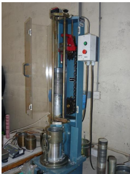
Slika 4.4: Naprava za Proctorjev preskus
