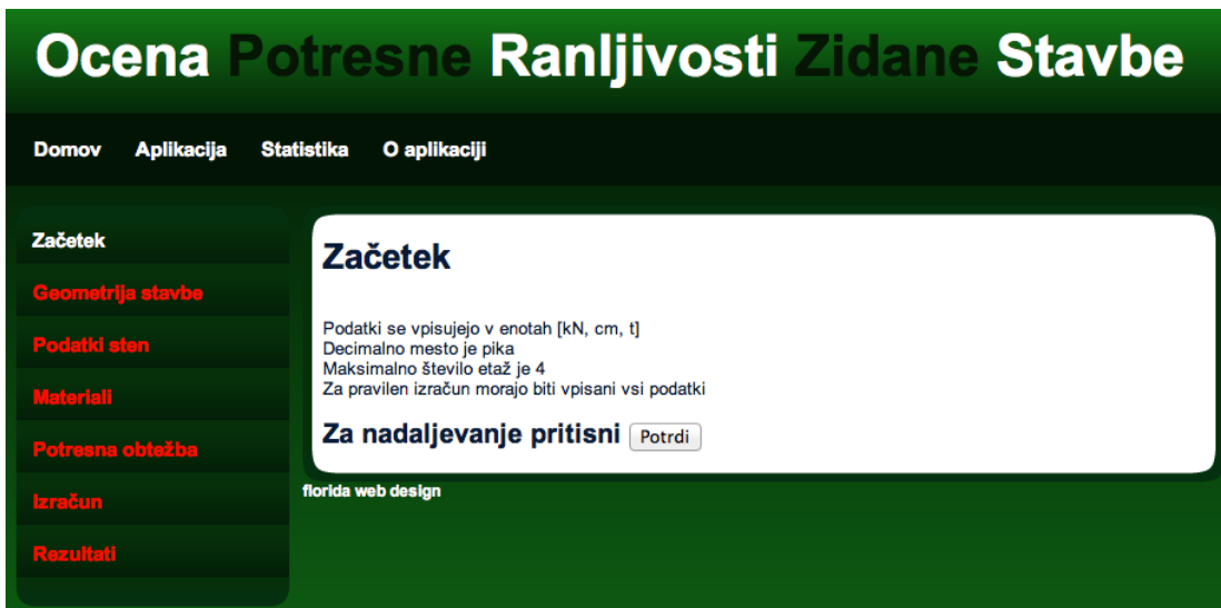
Slika 18: Začetna stran izračuna ranljivosti stavbe
