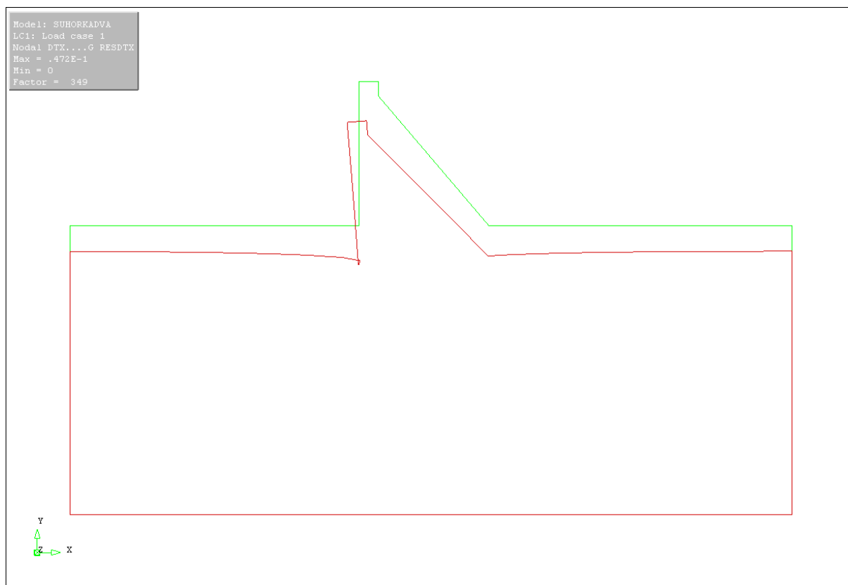
Slika 15: Deformirana oblika pregrade – lastna teža: faktor povečave (349)
