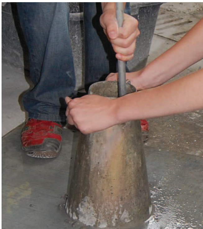
Slika 6: Nabijanje s standardno kovinsko palico
