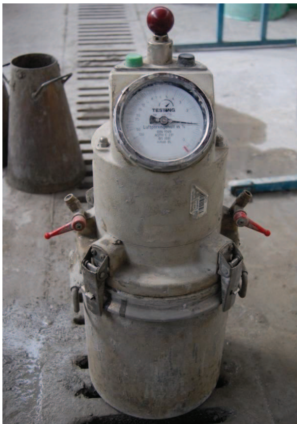
Slika 10: Posoda za merjenje zraka v betonu
