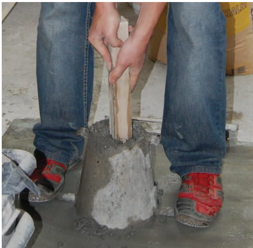
Slika 8: Nabijanje plasti z lesnim nabijačem
