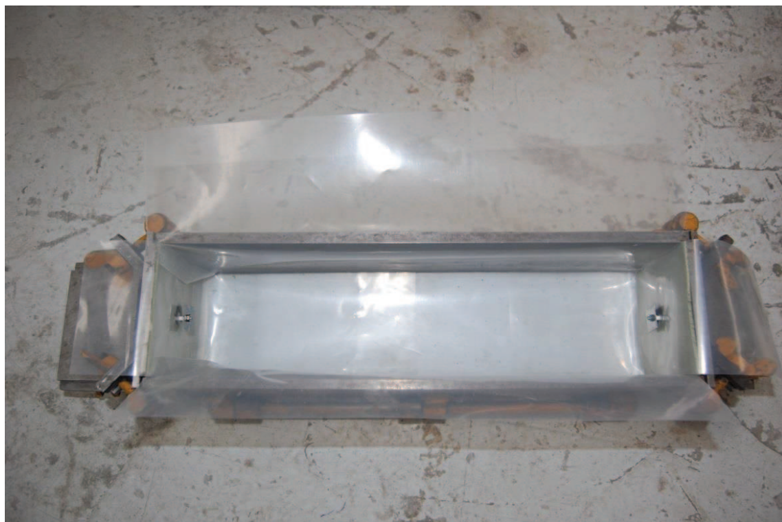
Slika 11: Pripravljen kalup za vgraditev betona
