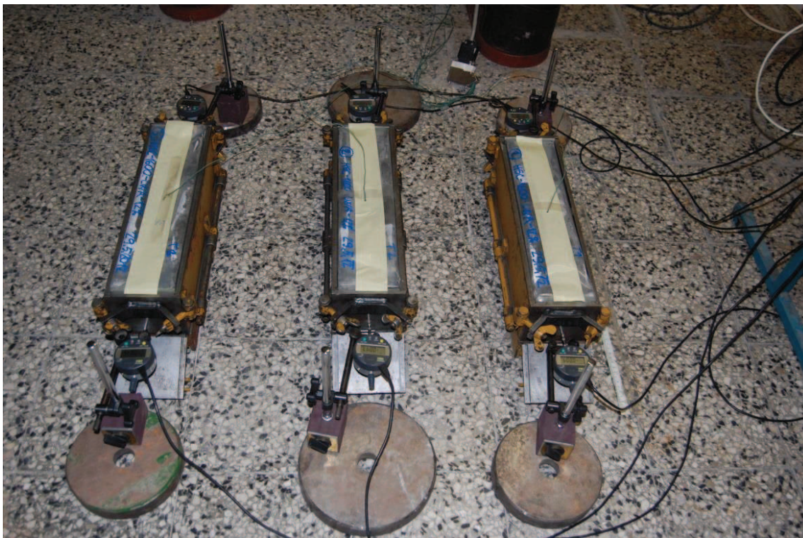
Slika 13: Elektronsko merjenje avtogenega krčenja preizkušancev
